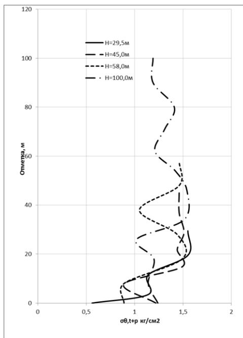
Рис. 10. Эпюры тангенциальных напряжений от перепада температуры по толщине ствола и воздействия стяжных колец,  $\sigma_{\theta,t+p}$  кг/см<sup>2</sup>
