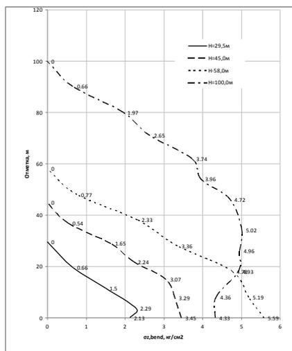
Рис. 8. Эпюры нормальных напряжений  $\sigma_{z,bend}$  в горизонтальных сечениях от изгибающих моментов, кг/см<sup>2</sup>
