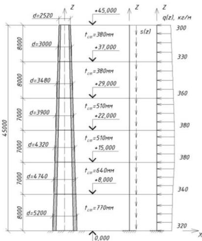
Рис. 2. Расчетная схема ствола кирпичной дымовой трубы  $H=45,0$  м
