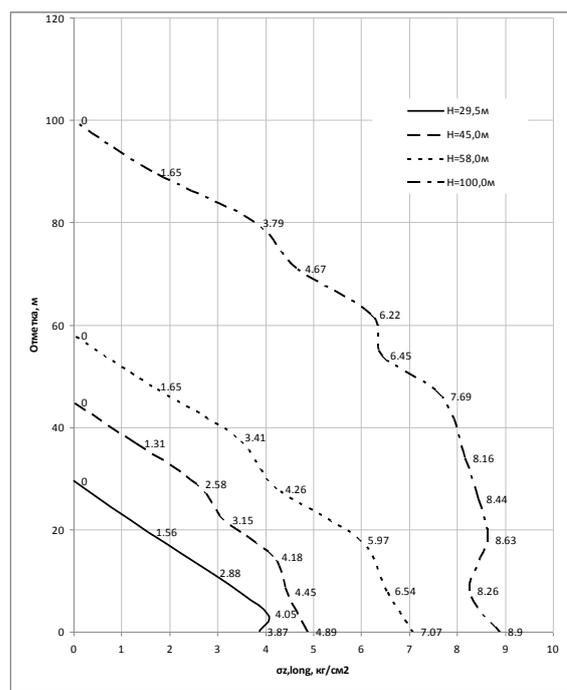
Рис. 7. Эпюры нормальных напряжений  $\sigma_{z, long}$  в горизонтальных сечениях от продольных сил, кг/см<sup>2</sup>
