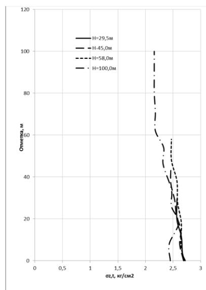
Рис. 9. Эпюры продольных температурных напряжений,  $\sigma_{z,t}$  кг/см<sup>2</sup>
