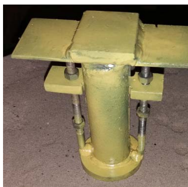
Рис. 2. Фото фрагментів плит залежно від діаметра і площі навантаження ґрунту: а – 38,4 см 2 (75 мм); б – 116,9 см 2 (125 мм); в – 234,7 см 2 (175 мм)
