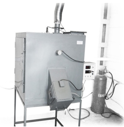
Рис. 1. Установа для термогравіметричних досліджень ефективності вогнезахисту засобів для вогнезахисту деревини
