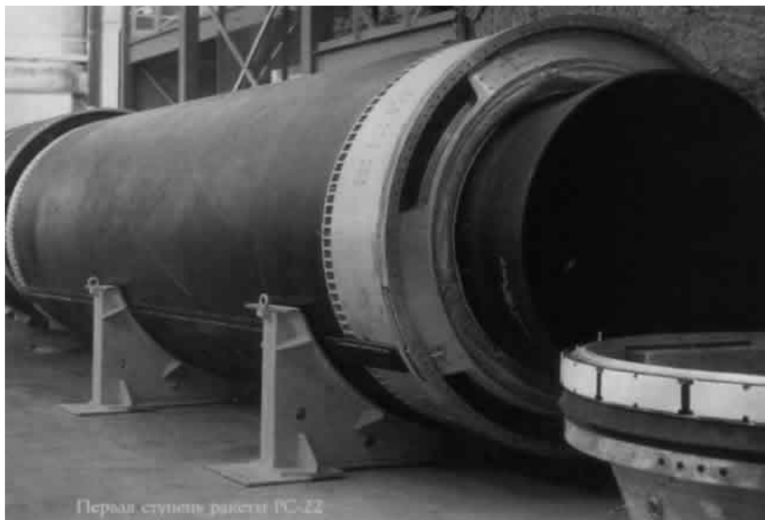
Рис. 3. I ступень межконтинентальной баллистической ракеты РС-22
