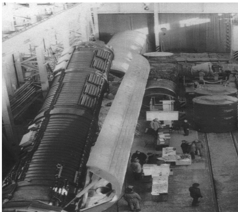
Рис. 1. Межконтинентальная баллистическая ракета РС-22 в железнодорожной мобильной пусковой установке (ЖМПУ)
