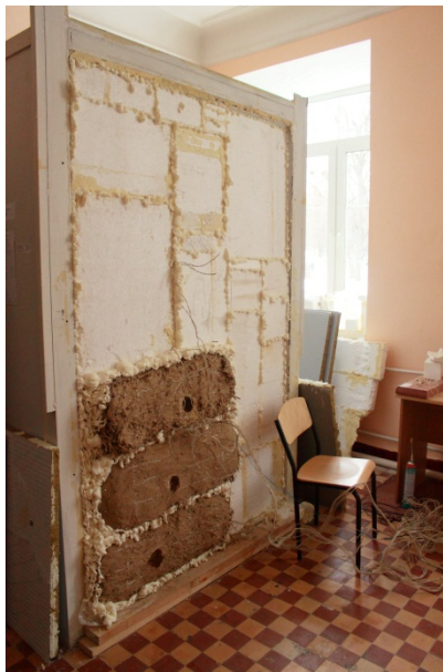
Рис. 2. Загальний вигляд експериментального фрагмента в температурній камері
