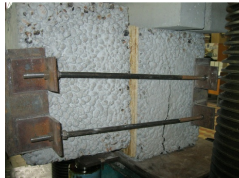
Рис.10. Утворення тріщин в бетонних призмах
