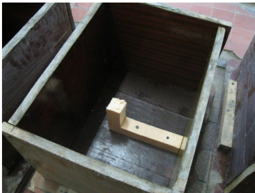
Рис. 1. Опалубочная форма с вкладышем из пенополистирола
