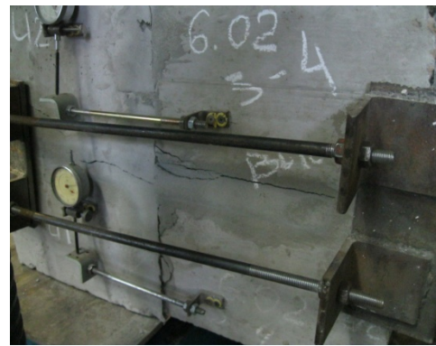
Рис. 8. Образование трещин по контакту растворного шва
