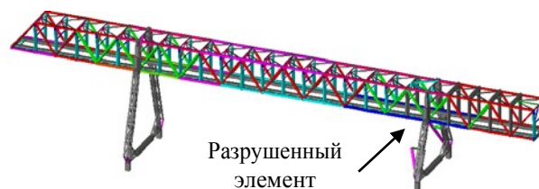
Рис. 8. Схема перегружателя с разрушенным опорным подкосом
