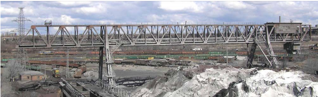
Рис. 3. Мостовой перегружатель решетчатой конструкции с гибкой и жесткой опорами
