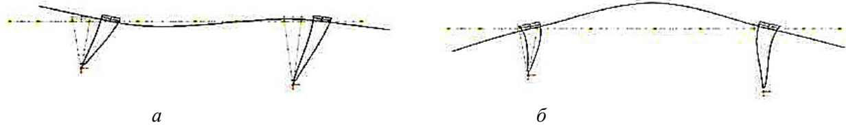
Рис. 1. Основные формы собственных колебаний перегружателя: а – продольно-горизонтальная на частоте 0,64 Гц; б – вертикальная на частоте 1,61 Гц
