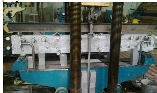
Рис. 2. Общий вид стенда для испытания балочных образцов в лабораторных условиях
