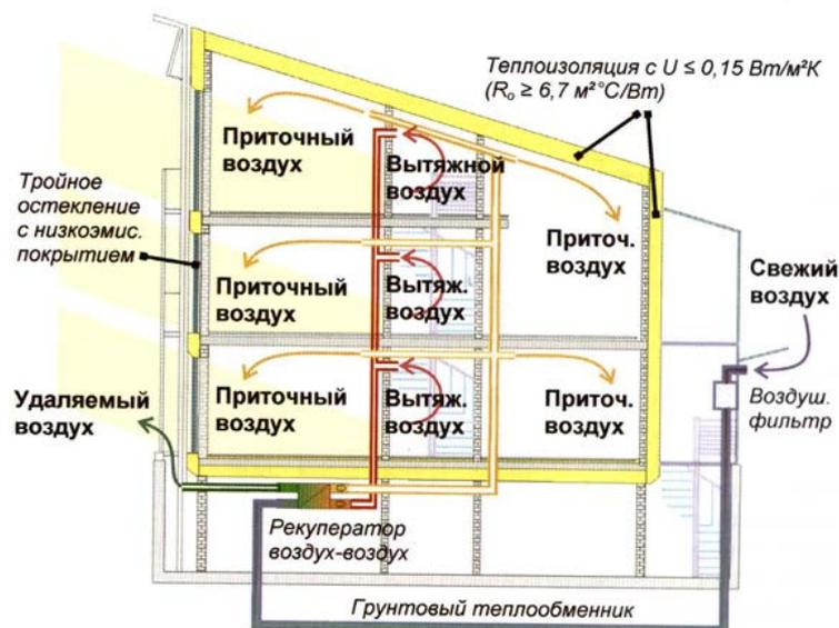
Рис. 2. Схема пассивного дома
