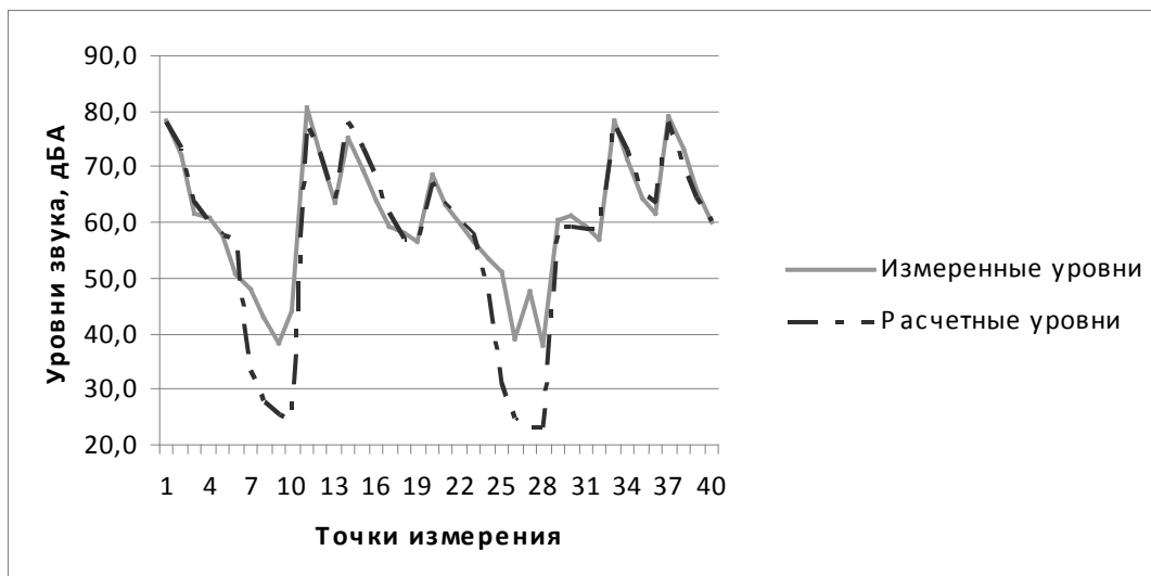
Рис. 4. Сравнение результатов натуральных инструментальных измерений и картографического прогноза шумового режима территории обследованной жилой застройки
