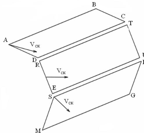
Рис. 4. Расчетная схема для лопасти, расположенной под углом к направлению скольжения
