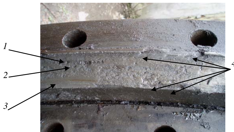
Рис. 3. Фрагмент верхнього кільця ОПК з ознаками пітингу (1), викришування поверхні кочення (2), луцення (3), руйнування кромки доріжки кочення (4)
