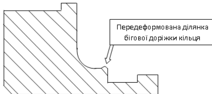
Рис. 2. Перетин нижнього кільця ОПК з передеформованою ділянкою металу поверхні кочення бігової доріжки
