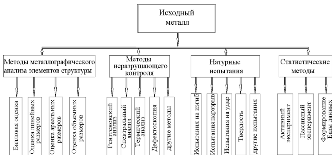
Рис. 3. Методы определения характеристик качества металла
