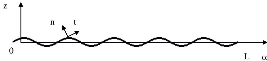
Рис. 1. Гофрированный стержень  $z = H \sin \frac{2\pi n\alpha}{L}$ ,  $n = 5$
