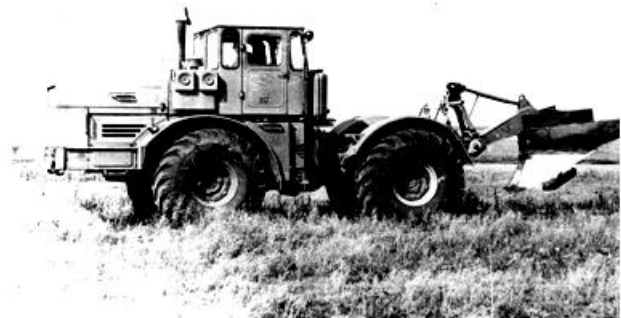
Рис. 6. Плужный каналокопатель МК-12 с газовой смазкой, смонтированный на базовом тракторе К-700 А
