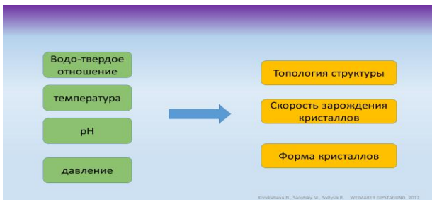
Рис. 1. Топологія структури, швидкість і форма зародження кристалів / Fig. 1. Topology of structure, velocity and form of crystal formation
