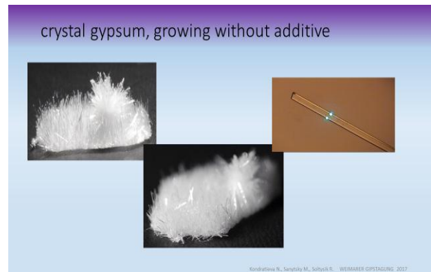
Рис. 4. Вирощені кристали гіпсу з насичених розчинів \text{CaCl}_2 , \text{Na}_2\text{SO}_4 без нанодобавок і пластифікатора / Fig. 4. Gypsum crystals grown from saturated solutions of \text{CaCl}_2 , \text{Na}_2\text{SO}_4 without nanowires and plasticizer
