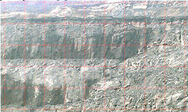
Рис. 1 а. Спарені уступи на південно-західному борті кар'єру ІнГЗК, поставлені в граничне положення методом контурного підривання ( \delta = 8 ) / Fig. 1 a. Paired ledges on the south western side of Inguletskyi GOK quarry that have been delimited by the contour blast method ( \delta = 8 )
