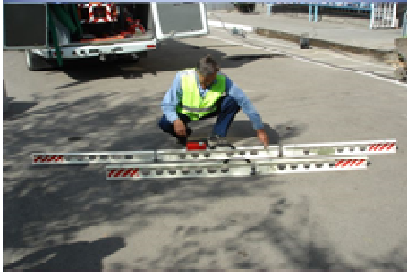
Рис. 4. Устройство для контроля геометрических параметров дорожного полотна, КП-232
