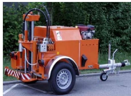
Рис. 3. Дорожный станок для отбора проб 2000 (ООО «Компанія Бі Ей Ві»)
