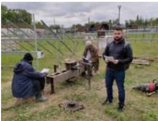
Натурні випробування багатопиткових паль на майданчику будівництва сонячної електростанції в м. Новомосковськ Дніпропетровської обл., асп. Ю. Ю. Волнянський (2020 р.)
