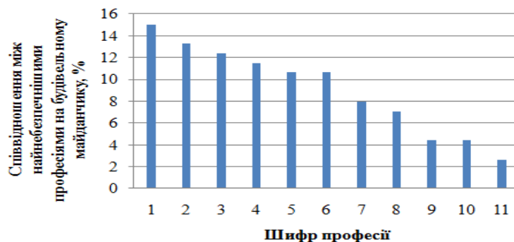
Рис. 8. Співвідношення найнебезпечніших будівельних професій на будівельному майданчику під час виконання робіт із реконструкції інженерних мереж: 1 – водій вантажної машини; 2 – монтажник; 3 – електрослюсар; 4 – машиніст; 5 – муляр; 6 – підсобний робітник; 7 – бетоняр; 8 – зварник; 9 – стропальник; 10 – виконроб (начальник відділу, групи); 11 – армувальник
