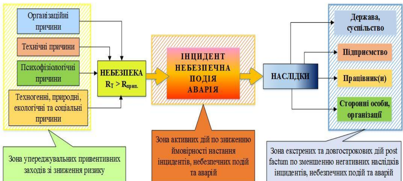
Рис. 1. Схема розвитку небезпечної події від формування небезпеки до прояву її наслідків та зони впливу на них
