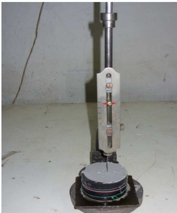
Рис. 1. Определение сроков схватывания жидкостекольной смеси
