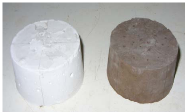
Рис. 2. Общий вид образцов после испытаний по определению сроков схватывания жидкостекольной смеси: 1 – на дистенсиллиманитовом концентрате с отвердителем; 2 – на комплексном вяжущем из жидкого стекла и глиноземистого цемента
