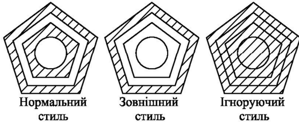
Рис. 5. Нанесення штрихування Fig. 5. Applying hatch patterns
