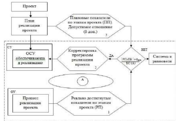
Рис. 4. Схема управления производственным процессом (ОУ – объект управления, СУ – субъект управления)
