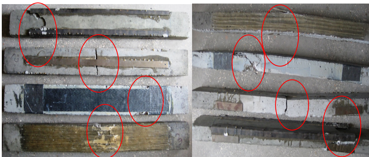
Рис. 7. Характер руйнування балок, підсилені різними методами, з відображенням місць руйнування
